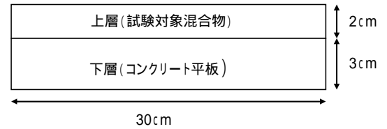
図-2 ホイールトラッキング試験用供試体
